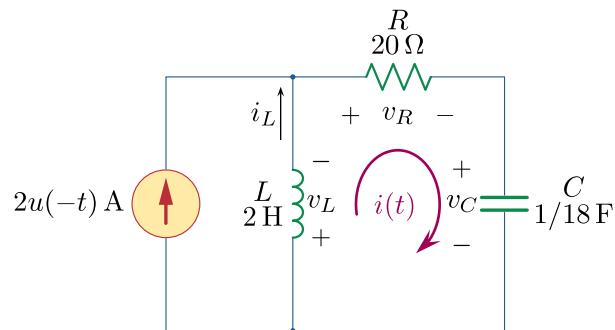
b) Calculate  $v_C(0+)$ ,  $v_R(0+)$ ,  $i_L(0+)$  and  $v_L(0+)$ . (2 points)
